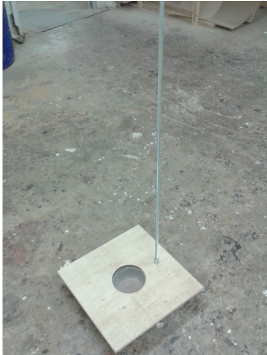
Figur 8. Sedimentfälla. Sedimentfällan består av en platta i plywood, över en burk i plast, fäst till en gängstav. Foto: Carolina Gårdefors.
