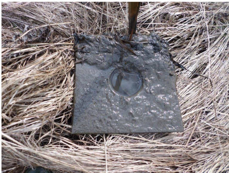
Figur 15. Sedimentfälla upptagen ur Stockbydamarna. Foto: Magnus Karlsson.
