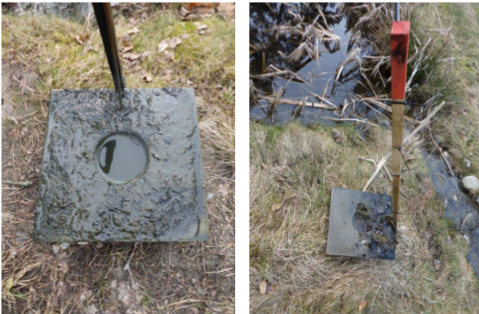
Figur 17-18. Sedimentfällor upptagna ur Södergarnsdammarna, till höger nära inloppet av dagvatten och till vänster nära inloppet av lakvatten. Foto: Magnus Karlsson.
