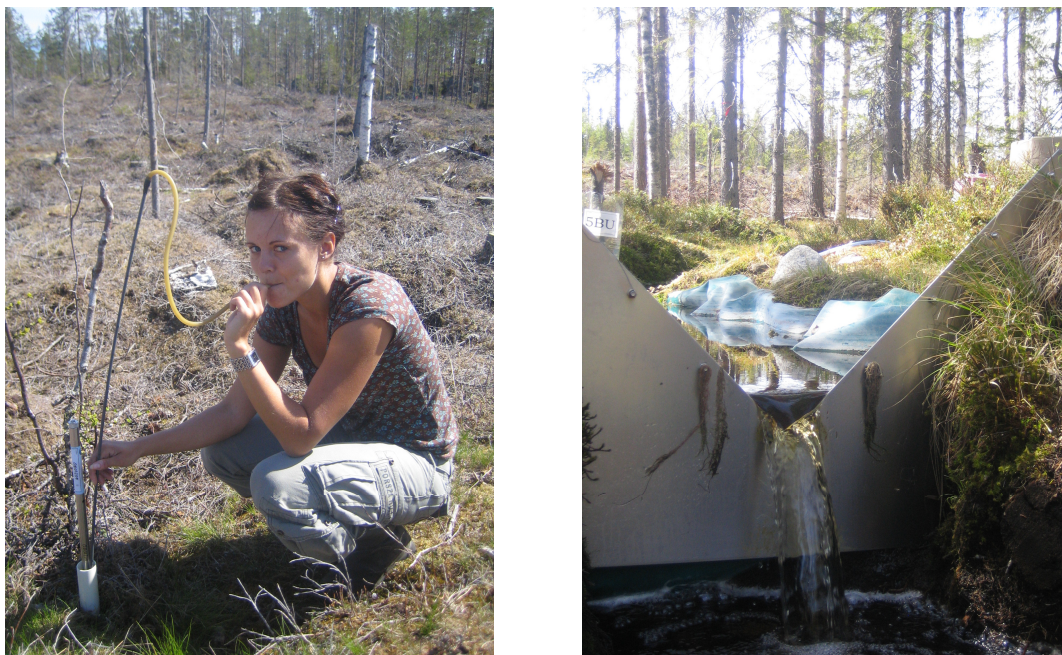
Figur 7. Manuell mätning av grundvattennivån (a), triangulärt överfall (b). (Foto: André Spans (a), Carolin Haglund (b))
