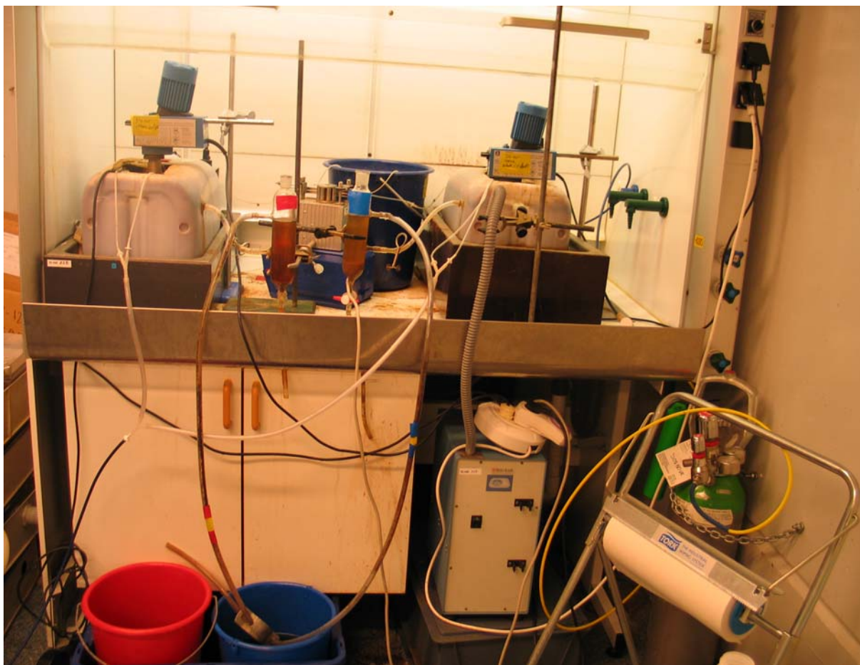
Figur 4. Laborationsuppställning med sommardammen (t.v.) och vinterdammen (t.h.). På stativ ovanför respektive damm kan omrörarna ses. Ingående vatten pumpades från hinken som ses placerad emellan dammarna. Utgående vatten från vardera dammen samlades upp i sommar- respektive vinterdammens uppsamlingshink, vilka kan ses placerade på golvet i nedre vänstra hörnet. Röd hink = sommardammens vatten, blå hink = vinterdammens vatten.
