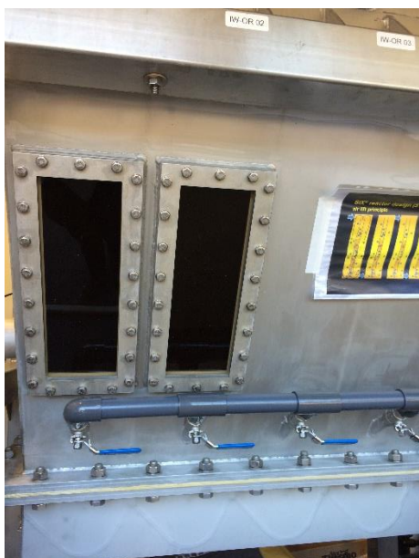
Figur 3. Fönster in till två av SIX-reaktorerna. Jonbytarna i suspension gör att vattnet ser svart ut.
