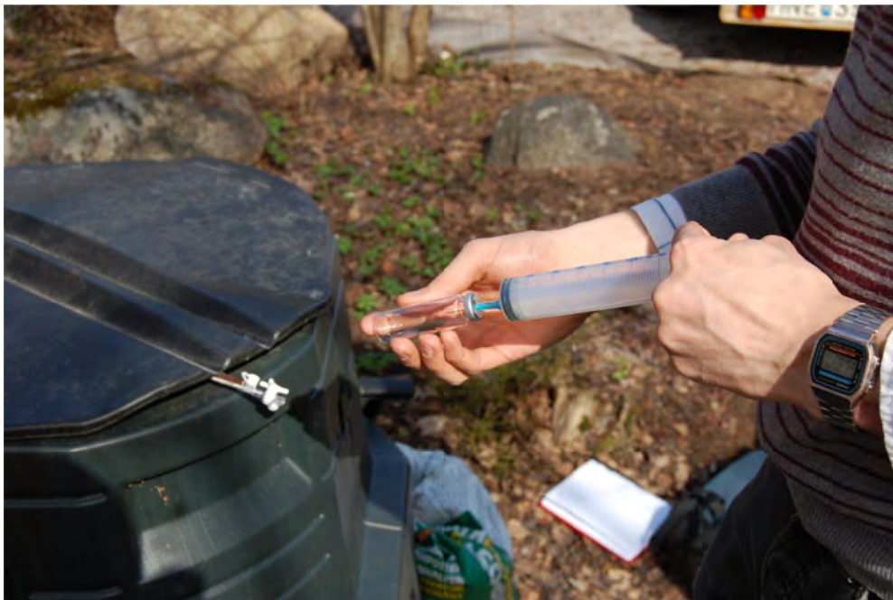
Figur 2. Fyllning av glasampull med kompostgas via injektionssprutan. Till vänster slangen införd i kompostbehållaren. Foto: Evgheni Ermolaev
