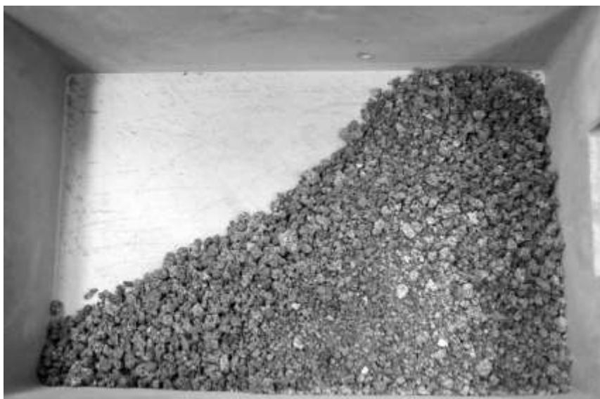
Figur 4. Nykrossad, icke siktad slagg.
