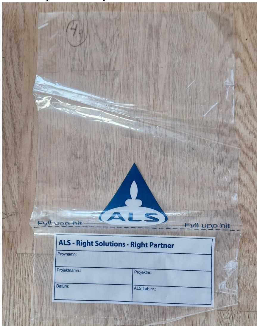
Figur A11.1: Diffusionspåse som används för analys av jord från laboratoriet ALS Scandinavia AB.
