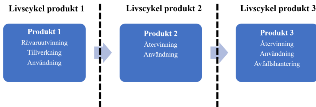
Figur 7. Återvinning med enkel cut-off för produkt 1, 2 och 3 enligt EPD-systemet (Ekvall et al. 2020).
