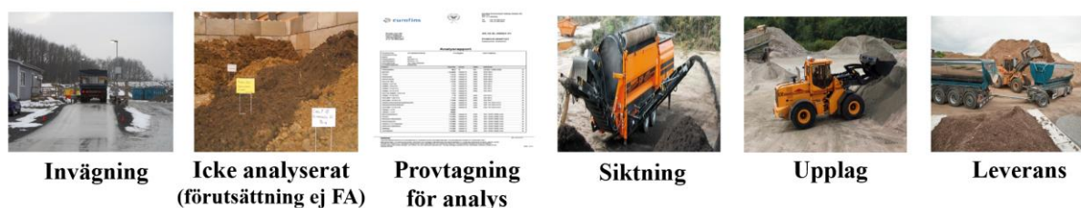
Figur 4. Princip för hantering av massor på mottagningsanläggning från vänster till höger 2 .
