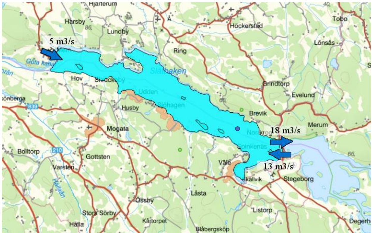
Figur 4. Karta med Slätbaken (ljusblå markering) och dess vattenbalans, in- och utflöde markerade med pilar. Över tröskeln flödar det på årsbasis i genomsnitt 18 m 3 /s ut och 13 m 3 /s
