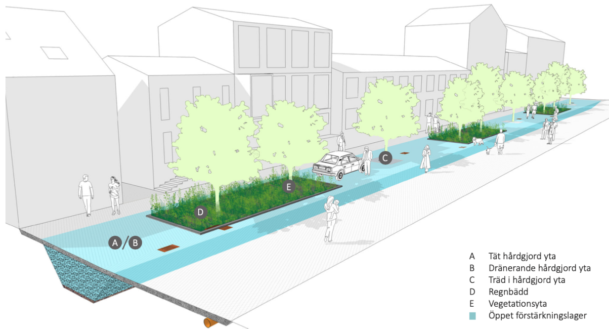
Figur 7: Översiktbild på ett stråk av BGG-system som anläggs i gatans flexzon. I markplan varvas hårdgjorda ytor med regnbäddar, vegetationsytor och träd på ett flexibelt sätt. Bildkälla: Edge
