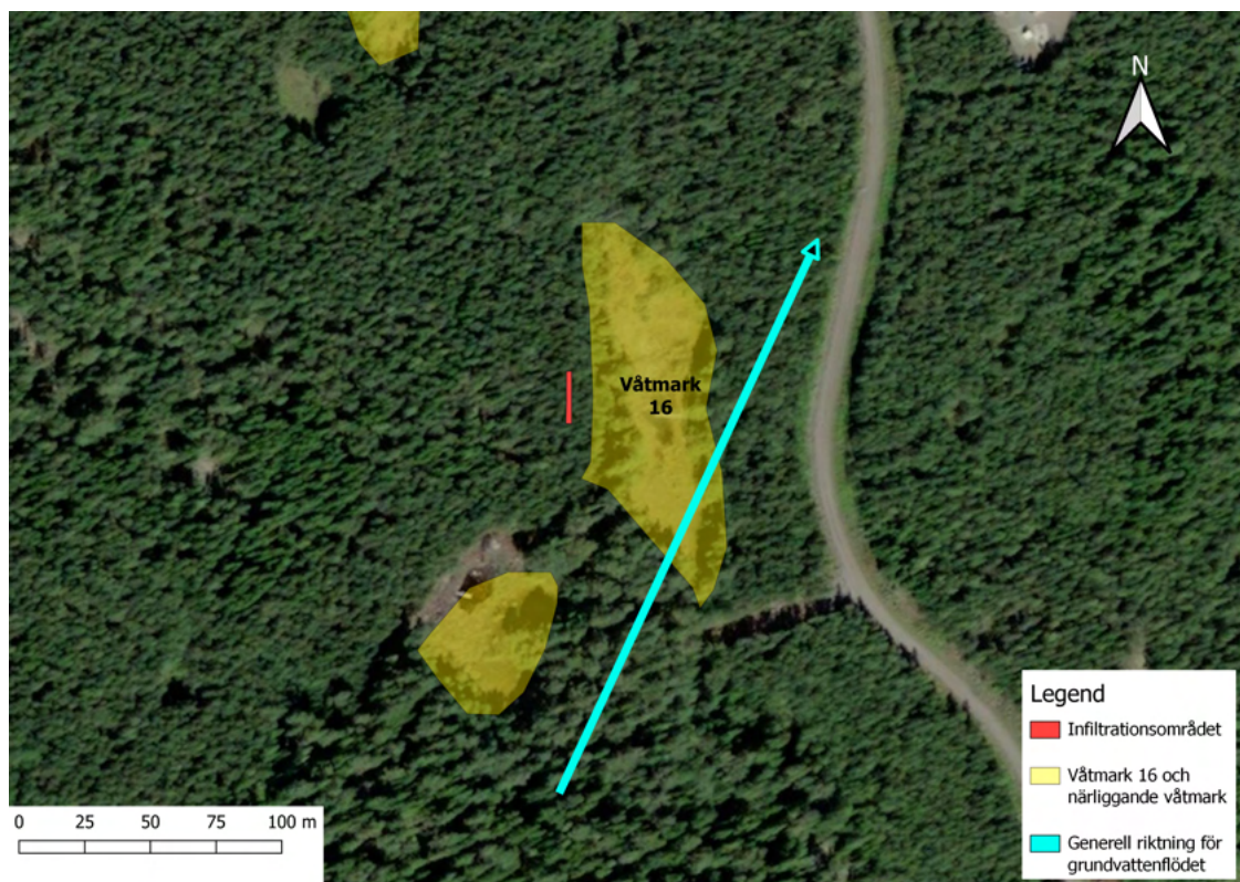
Figur 3. De markerade våtmarksobjekten i området och det utmarkerade infiltrationsområdet. Den blåa pilen representerar en generell flödesriktning baserat på topografi och den hydrauliska potentialen. Våtmark 16 är utmärkerad som våtmarken av intresse. Bakgrundskarta tagen från © Bing Virtual Earth.
