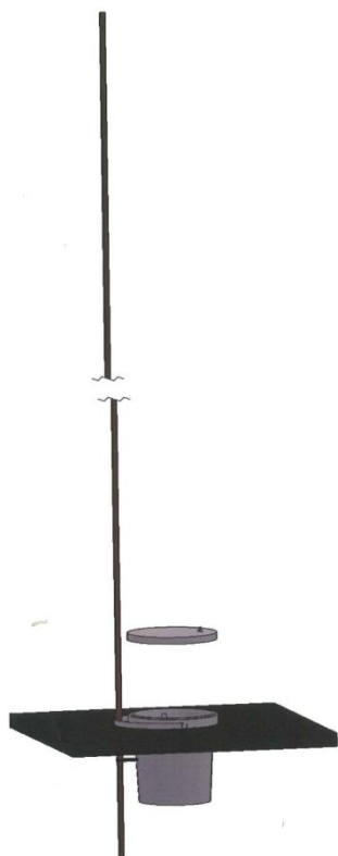
Figur 16. Modell av den slutgiltiga versionen av sedimentfälla, modellerad i Solid Works av Annika Persson.
