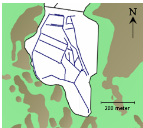
Figur 11. Skiss av lakvattensystemet i uppsamlingsområdet L2 enligt Renova (2000b). De blå linjerna inom L2-området markerar dränering liggande på den ursprungliga markytan. De gråbruna områdena markerar ytligt berg.
