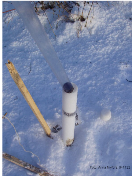
Figur 6 Fotot till vänster visar borrhandsvagnen vid borrning av provpunkt 3. Fotot till höger visar grundvattenrör 7 och vattentömning av det med en bailer.
