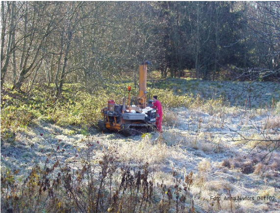
Figur 6 Fotot till vänster visar borrhandsvagnen vid borrning av provpunkt 3. Fotot till höger visar grundvattenrör 7 och vattentömning av det med en bailer.
