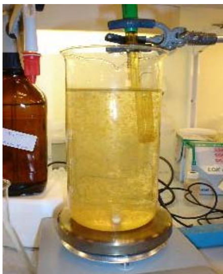
Fig. 6 Labuppställning, 1-litersbägare som flockningsbassäng och magnetomblandare som omrörare (foto: Anna Nilsson).
