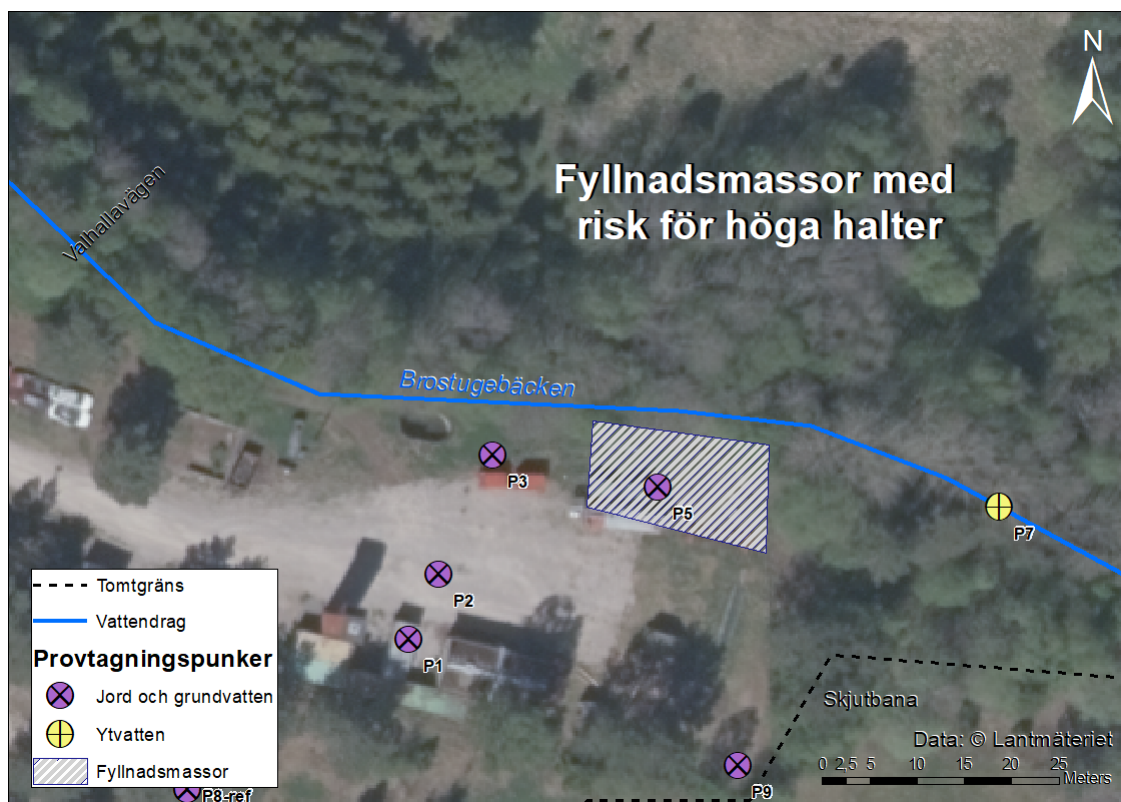
Figur 12: Bedömd utbredning av de ytliga fyllnadsmassor som återfinns i provtagningspunkt P5. Området med fyllnadsmassor avgränsas i väst av provtagningspunkten P3, samt av tydliga slänter och staket ned mot bäcken och mot fastighetsgränsen i öster.
