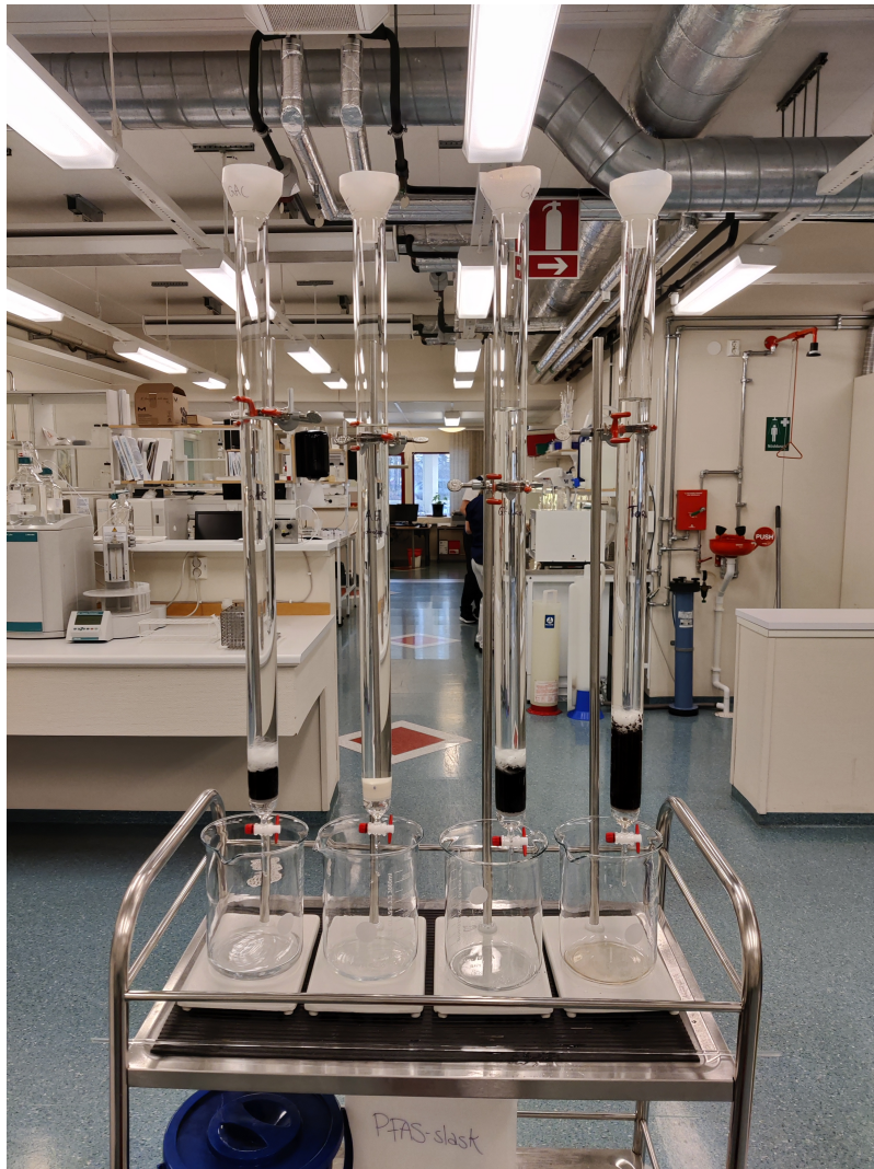
Figur 7: Uppställning av kolonner packade med adsorbent där ordningen från vänster är: GAC, AE, grillkol och torv. I kolonnerna med GAC, grillkol och torv placerades glasull ovanpå adsorbenten för att förhindra att den flöt upp vid tillsats av vatten.
