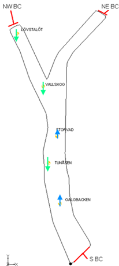
Figur 13 En förenklad illustration av inflöden (gröna), utflöden (blå) och randvillkor (röda) i den matematiska modellen. Bilden är skapad av Jean-Marc Mayotte och publicerad med tillstånd.
