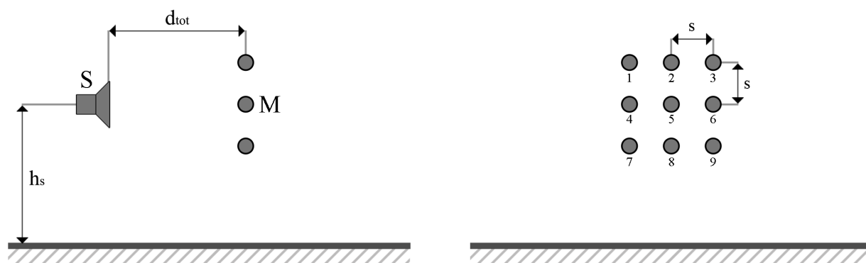
Figur 4. Skiss över mikrofonuppställningen för frifältsmätningen (ej skalenlig). Figuren till vänster är mätuppställningen sett från sidan och figuren till höger är mätuppställningen sett framifrån. Förklaring av beteckningarna: (vänster) S = ljudkälla (högtalare); M = ljudmätare (mikrofoner); h_s = 0,5 m x bullerskyddsskärmens höjd; d_{TOT} = 1,25 m + bullerskyddsskärmens tjocklek; (höger) s = 0,4 m (avstånd mellan mikrofonerna). Numreringen i figuren till höger visar mikrofonnumreringen.
