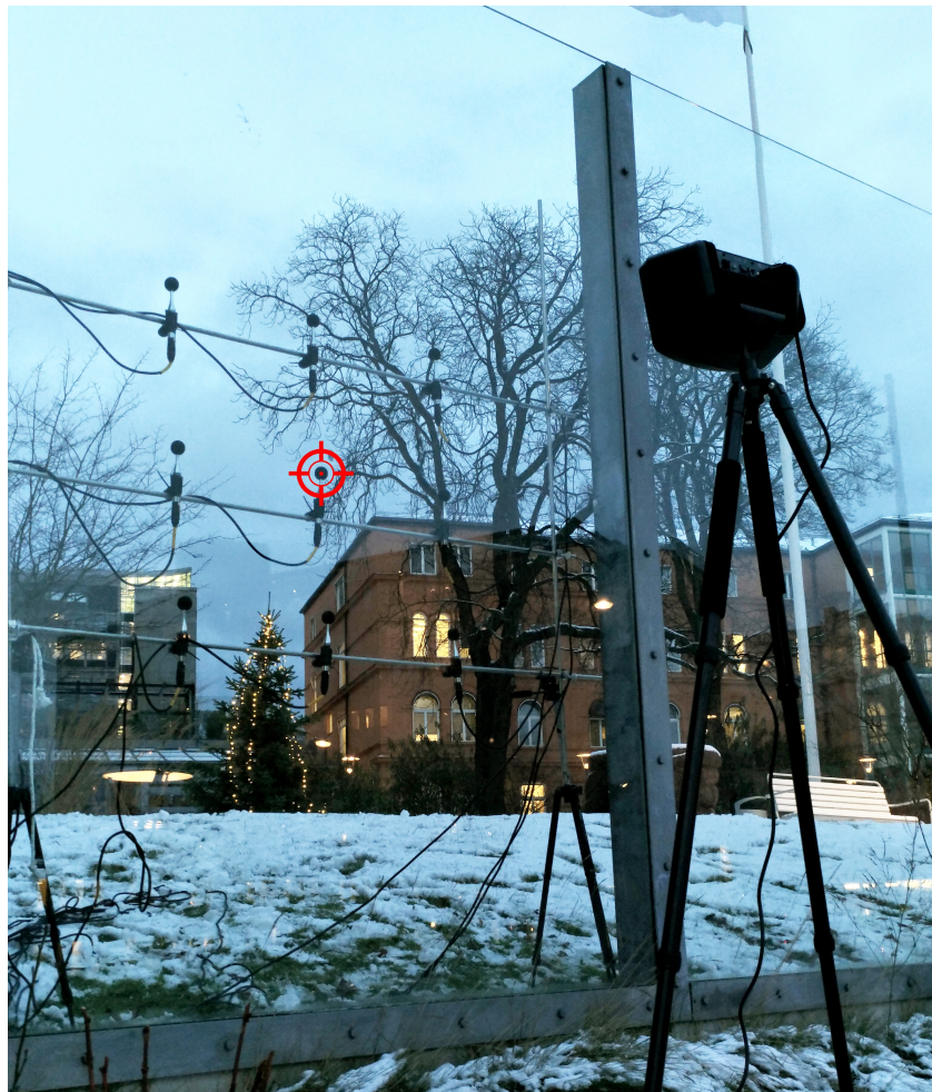
Figur 7. Bild på högtalar- och mikrofonuppställningen för mätning av bullerskyddsskärmen vid Fridhemsplan, från den trafikerade vägen. De röda cirklarna visar vart mätningarna utfördes.
