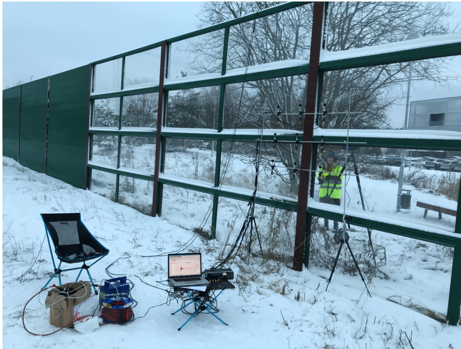
Figur 10. Mätuppställning för mätning på pelaren mellan skärmelementen i kombinerat glas för bullerskyddsskärmen i Knivsta.
