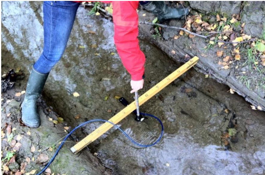
Figur 9. Provtagning med elektromagnetisk flygel i Provpunkt 2, bäcken.
